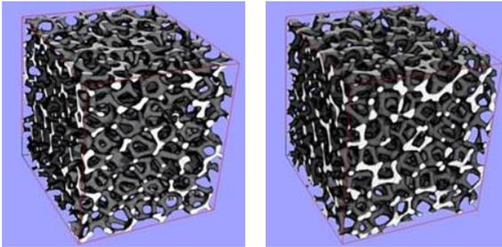
Welcher Schaum ist echt? Volumenrendering eines rekonstruierten CT-Bilds eines offenzelligen Metallschaums (links) und des angepassten Modells (rechts).
