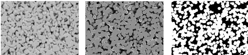
Wie trainiert man ein neuronales Netz zur Bildsegmentierung, wenn man keine realen Trainingsdaten hat? Von links nach rechts: Reales FIB-REM-Bild eines porösen Werkstoffs, simuliertes FIB-REM-Bild und bekannte Grundwahrheit (Realisierung eines stochastischen Geometriemodells).
